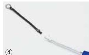
④ 先端のカバーを閉めて、途中で離さないようゆっくり通し返す。その後、指でしごいてラインの縮みを伸ばしながらしっかり締め込みます。
