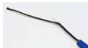
② 芯が抜かれて空洞になった部分からブレイドノッターを通し、おおよそ真ん中辺りから抜きます。カバー部分がすべて出るまで突き出してください。
